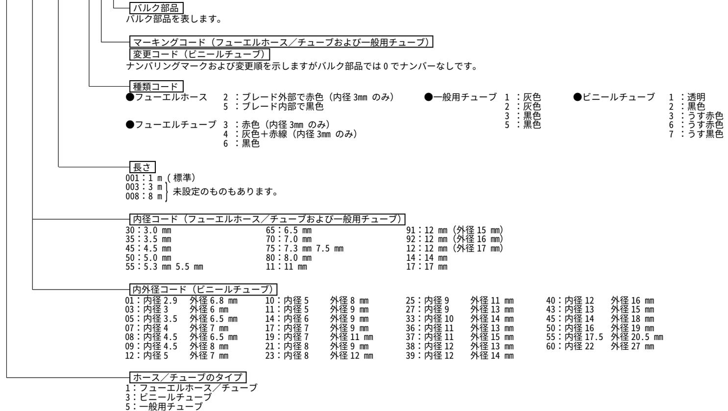
◎ 注意： フューエルホース／チューブと一般用チューブ、及びビニールチューブを間違えて使用すると危険が生じます。
