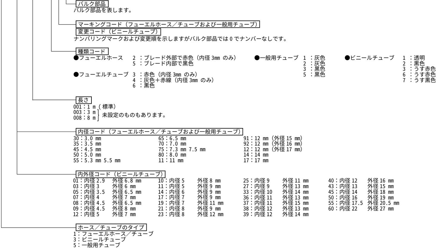
◎ 注意： フューエルホース／チューブと一般用チューブ、及びビニールチューブを間違えて使用すると危険が生じます。フューエルホース／チューブ使用箇所に一般用チューブ、及びビニールチューブを使用したり、その逆の使用は絶対しないで、パーツカタログ記載のバルク部品をサービスマニュアル及びバルク部品に同梱されている説明書に従って正しく使用してください。
