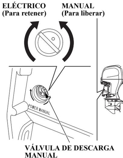
Cuando el sistema de trimado/ inclinación motorizados no opera debido a que se ha descargado la batería o a una avería del motor de trimado/ inclinación motorizados, podrá inclinar manualmente el motor fueraborda hacia arriba o abajo operando la válvula de descarga manual.
