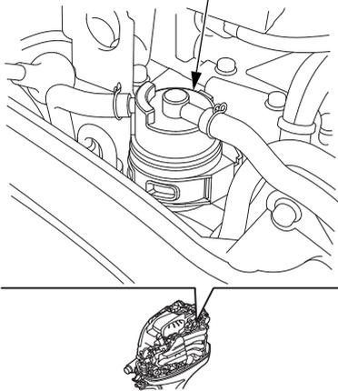
El filtro de combustible (dentro de la copela del filtro) está situado entre la bomba de combustible y el separador del agua.
