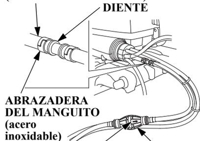
1. Extraiga el tapón de manguera de la manguera de combustible del lado del motor. Inserte la junta de la línea de combustible en la manguera de combustible del lado del motor y fíjela con la abrazadera de la manguera. Asegúrese de que la marca de la flecha de la pera de cebado señale hacia el lado del motor.
