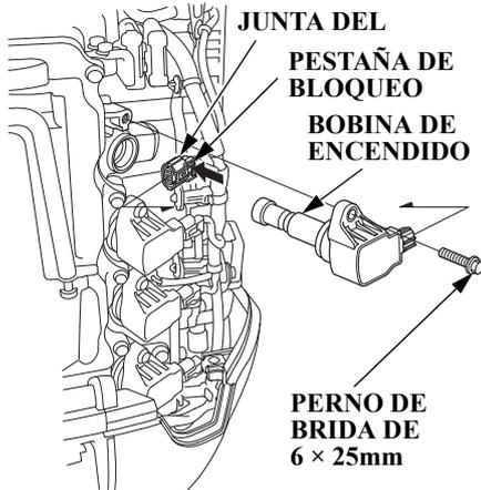
4. Extraiga el perno de brida de 6 × 25 mm.
