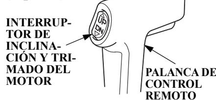
INTERRUPTOR DE INCLINACIÓN Y TRIMADO DEL MOTOR
