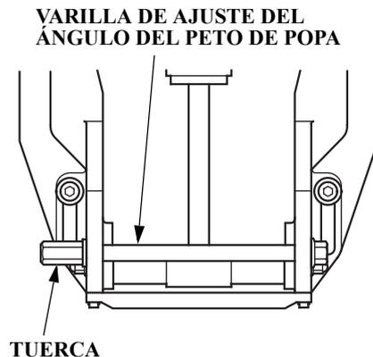
3. Insertando la barra de ajuste del ángulo del peto de popa en el orificio apropiado, apriétela con seguridad girándola hacia la derecha. Después de instalar la barra de ajuste, tire de la misma para asegurarse de que no sale de lugar.
