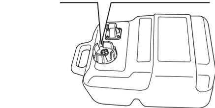
La perilla de ventilación de la tapa de llenado de combustible controla la entrada y salida de aire del depósito de combustible.
