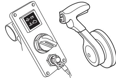
CAJA DE CONTROL DE MONTAJE EN LA CONSOLA Y PANEL DE INTERRUPTORES (PARA TIPO CON MOTOR FUERABORDA SENCILLO)
