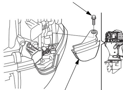
**CUBIERTA DE MANTENIMIENTO DE LA BUJÍA**
