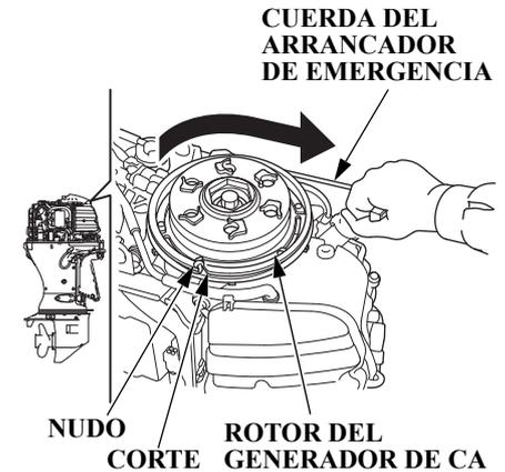
8. Coloque el rotor del generador de CA de modo que los cortes estén en los lados derecho e izquierdo del rotor del generador de CA como se muestra. Enganche el nudo del extremo de la cuerda del arrancador (accesorio) contra un corte del rotor del generador de CA y bobine la cuerda del arrancador una vuelta y media hacia la derecha a lo largo de la ranura del rotor del generador de CA.
