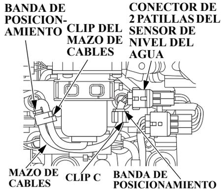
9. Conecte el conector de 2 patillas del sensor del nivel de agua. Instale el mazo de cables en el retenedor C y el retenedor del mazo de cables. Alinee las bandas de posicionamiento del mazo de cables con el extremo del retenedor C y el retenedor del mazo de cables como se muestra arriba.
