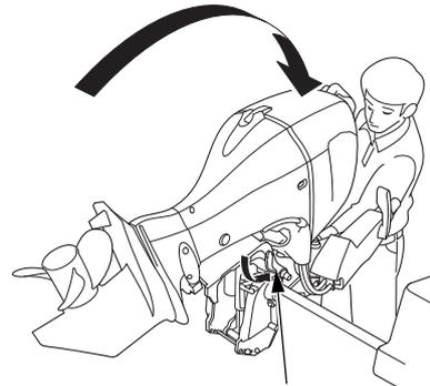
**PALANCA DE BLOQUEO DE INCLINACIÓN**
