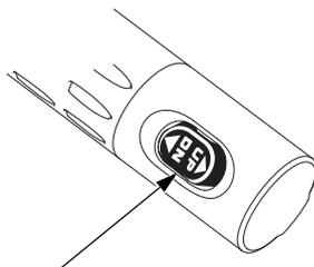
INTERRUPTOR DE INCLINACIÓN Y TRIMADO DEL MOTOR
