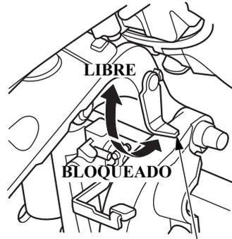
**PALANCA DE BLOQUEO DE INCLINACIÓN**
