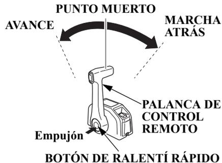
Utilice el botón de ralentí rápido y la palanca de control remoto para ajustar la velocidad del motor sin cambiar de marcha cuando esté calentando el motor. Presionando el botón de ralentí rápido, gire la palanca de control remoto hacia delante. Siga girando la palanca hacia delante. El acelerador se abrirá y la velocidad del motor aumentará después de que la palanca pase el punto de cambio.
