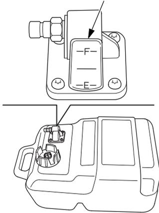
El indicador de combustible indica el nivel de combustible en el depósito.
