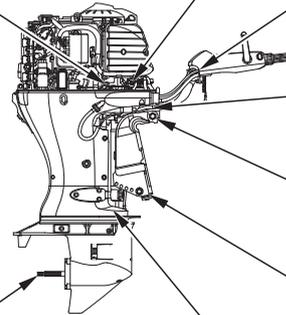
**SOPORTE DEL VARILLAJE DE CAMBIO/PIVOTE DEL INVERSOR/BRAZO DEL INVERSOR/
