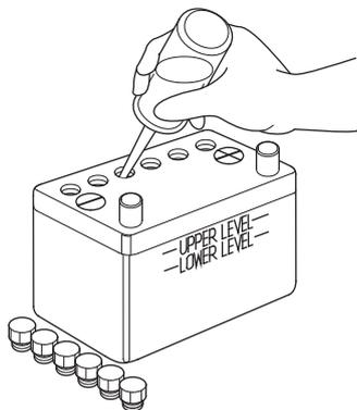
3. Llene la batería con agua destilada hasta la línea de nivel superior. Nunca llene demasiado la batería.
