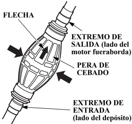
Sostenga la pera de cebado de modo que el extremo de salida esté más alto que el de entrada (de modo que la flecha de la pera de cebado señale hacia arriba), y bombéela hasta que note firmeza, lo cual es indicación de que el combustible ha llegado al motor fueraborda. Compruebe si hay fugas.
