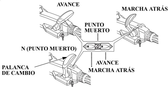
La palanca de cambios tiene 3 posiciones: FORWARD (avance), NEUTRAL (punto muerto), y REVERSE (marcha atrás). El indicador que hay en la base de la palanca de cambios se alinea con el icono adherido a la caña de timón.
