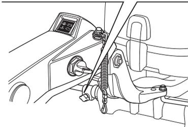
Emplee la perilla de ajuste de la fricción de la dirección para ajustar la fricción de la caña del timón. Girándola hacia la derecha se aumenta la fricción, y girándola hacia la izquierda se reduce la fricción.
