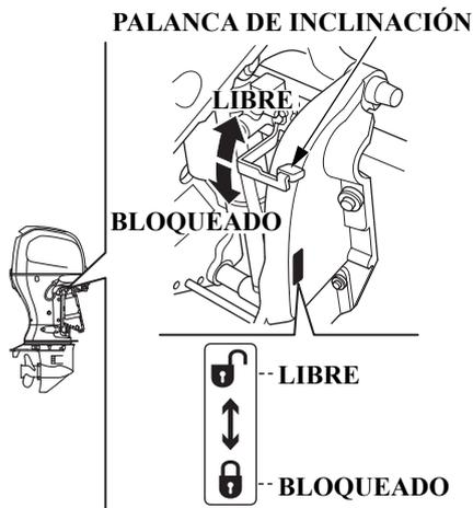
Emplee la palanca de inclinación para elevar temporalmente el motor fueraborda cuando la embarcación pasa por aguas poco profundas, o para amarrar o anclar en aguas poco profundas.
