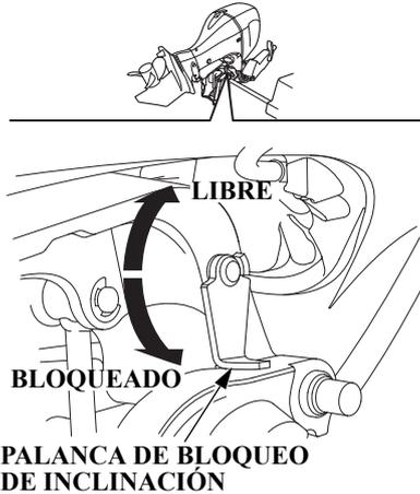
Emplee la palanca de bloqueo de la inclinación para elevar el motor fueraborda y bloquearlo en la posición cuando la embarcación esté amarrada o se deje anclada durante períodos prolongados.
