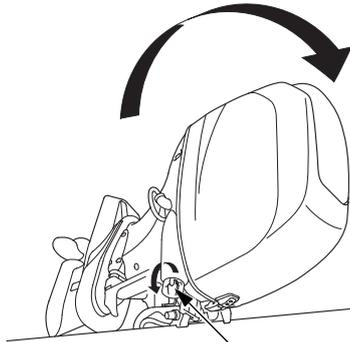
PALANCA DE BLOQUEO DE INCLINACIÓN
