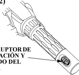
INTERRUPTOR DE INCLINACIÓN Y TRIMADO DEL MOTOR
