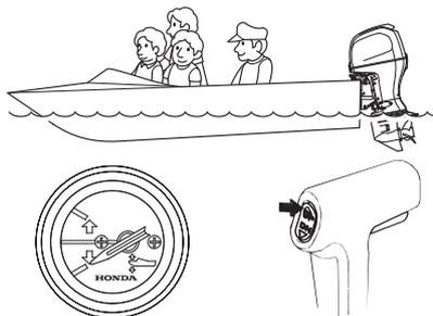
Con el motor fueraborda trimado bajo, el medidor de trimado indicará tal como se muestra. Para subir el casco, aumente el ángulo de trimado del motor fueraborda presionando la parte UP (arriba) del interruptor de trimado/inclinación motorizados.
