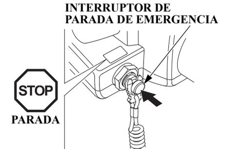
Presione el interruptor de parada de emergencia para detener el motor.
