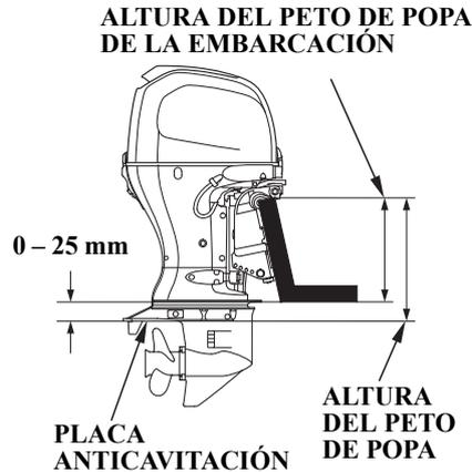
La placa anticavitación del motor fueraborda debe quedar de 0 a 25 mm por debajo de la parte inferior de la embarcación.
