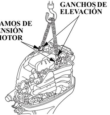
2. Coloque los ganchos de la grúa contra los dos soportes del motor y cuelgue el motor fueraborda para extraerlo de la embarcación.
