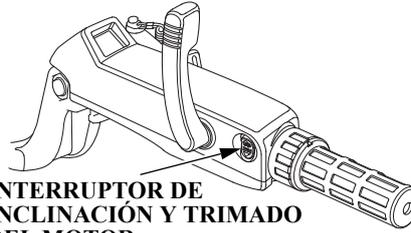
INTERRUPTOR DE INCLINACIÓN Y TRIMADO DEL MOTOR
