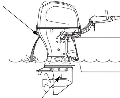
ORIFICIO DE ADMISIÓN DE AGUA DE REFRIGERACIÓN (ambos lados)
