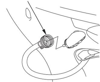
4. Desconecte el conector del orificio de lavado.
