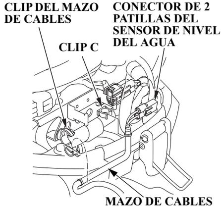
3. Abra el retenedor del mazo de cables y extraiga el mazo de cables del clip C, y desconecte entonces el conector de 2 patillas del sensor del nivel de agua.
