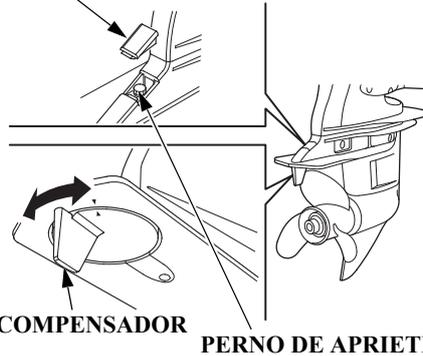
Si se gira la manija/timón de dirección hacia un lado mientras se navega a toda velocidad, ajuste el compensador para que la embarcación navegue hacia delante en línea recta
