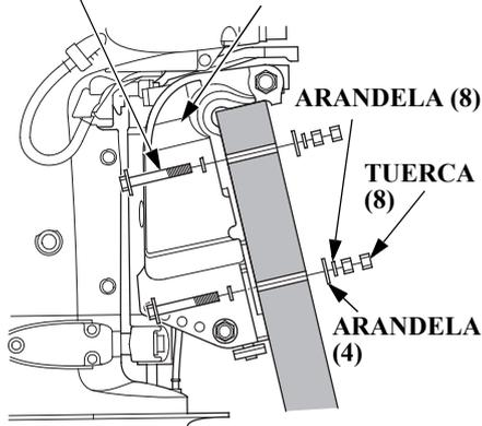
1. Aplique sellante de silicona (Three Bond 1216 o equivalente) a los orificios de fijación del motor fueraborda.
