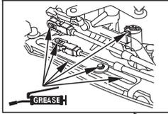
**PALANCA DE BLOQUEO DE INCLINACIÓN (ambos lados)**
