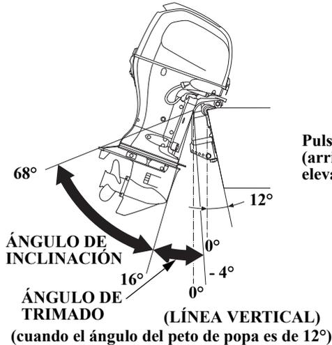
Los tipos BF75D/80A/90D/100A T están equipados con el sistema de trimado/inclinación motorizados que puede ajustar el ángulo del motor fueraborda (ángulo de trimado/inclinación) durante la navegación y el amarre. El ángulo del motor fueraborda también puede ajustarse durante la navegación y la aceleración para obtener la velocidad máxima así como la navegación y economía de combustible óptimas.
