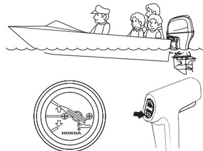
Con el motor fueraborda trimado alto, el medidor de trimado indicará tal como se muestra. Para bajar el casco, reduzca el ángulo de trimado del motor fueraborda presionando la parte DN (abajo) del interruptor de trimado/inclinación motorizados.
