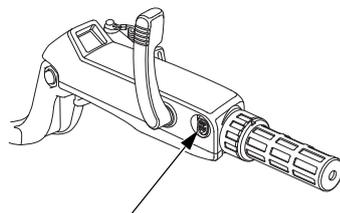
INTERRUPTOR DE INCLINACIÓN Y TRIMADO DEL MOTOR
