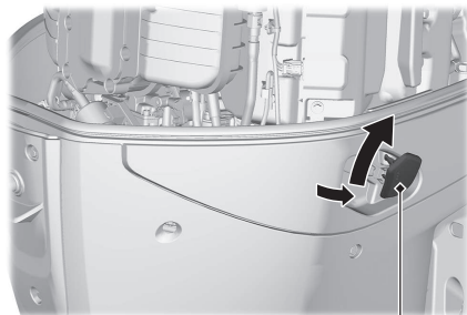
エンジンカバー固定レバー（左右両側）
