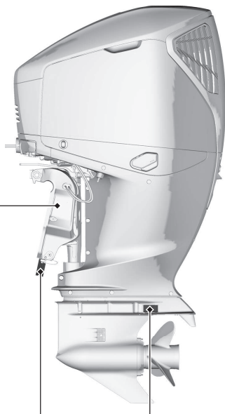
アノードメタルの損傷、 腐食、がた (50頁参照)
