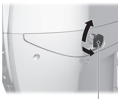
エンジンカバー固定レバー（左右両側）
