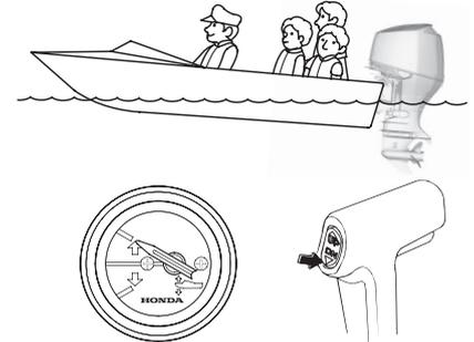
Con el motor fueraborda trimado alto, el medidor de trimado indicará tal como se muestra. Para bajar el casco, reduzca el ángulo de trimado del motor fueraborda presionando la parte DN (abajo) del interruptor de trimado/inclinación motorizados.
