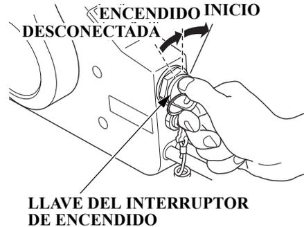
4. Gire la llave del interruptor de encendido a la posición INICIO hasta que el motor arranque. Cuando el motor arranque, suelte la llave dejándola volver a la posición ON.
