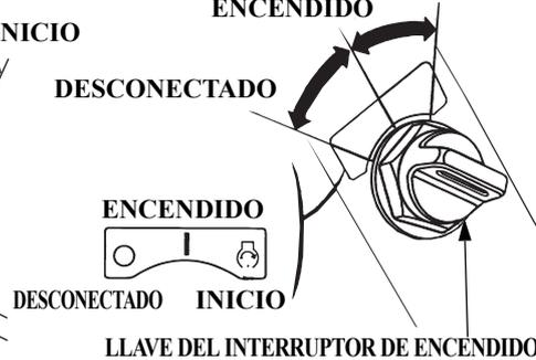
En el tipo de montaje lateral (tipo R1), el interruptor de encendido está situado a su lado cerca de la caja de control remoto.
