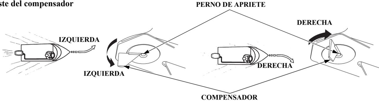
La lengüeta de trimado está provista para "girar la dirección descentrada" que es una reacción de la rotación de la hélice o torsión de la hélice. Si durante un giro a alta velocidad se requiere un esfuerzo desigual para girar la embarcación hacia la derecha o izquierda, ajuste el compensador de modo que se requiera un esfuerzo equivalente.
