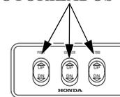
1. Presione la parte DN (abajo) del interruptor de trimado/inclinación motorizados y efectúe el trimado del motor fueraborda a la posición más baja.
