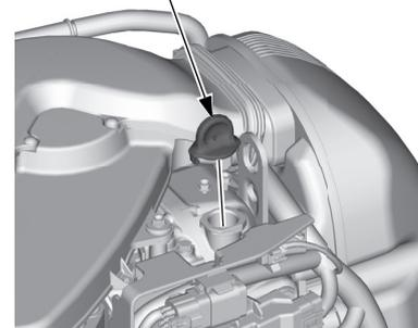
Cuando el aceite del motor está contaminado o descolorado, reemplace con aceite de motor nuevo (véase la página 127 para saber los intervalos y el método de sustitución).
