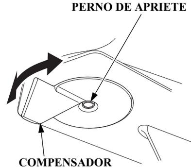
Si se gira el volante hacia un lado mientras se navega a toda velocidad, ajuste el compensador para que la embarcación navegue hacia delante en línea recta.
