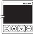
Se apaga el indicador de la presión de aceite y suena el zumbador cuando el nivel de aceite es bajo y/o el sistema de lubricación del motor está defectuoso. Entontes, la velocidad del motor se reduce gradualmente.
