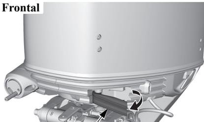
ENGANCHE DE LA CUBIERTA DEL MOTOR
