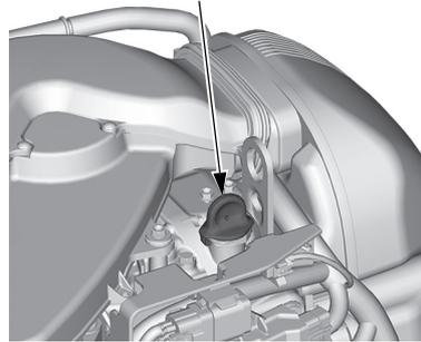
5. Introduzca la varilla hasta el fondo. Vuelva a instalar la tapa de llenado de aceite con seguridad. No lo apriete demasiado.
