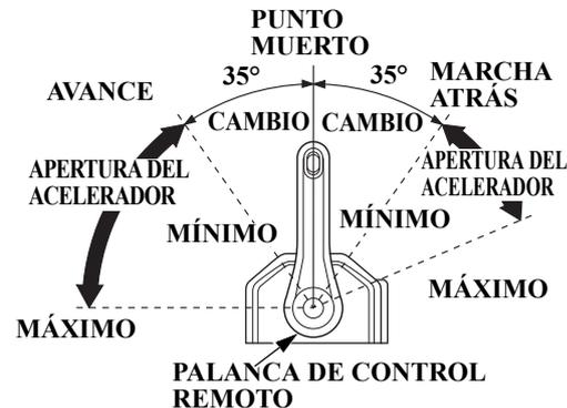
Cambiar a marcha adelante, marcha atrás o punto muerto y el ajuste de la velocidad del motor puede realizarse con la palanca de control remoto.
