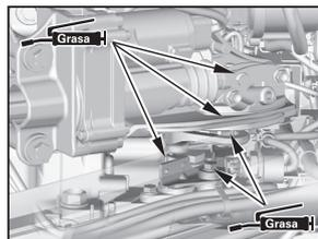
**PALANCA DE BLOQUEO DE LA INCLINACIÓN**
