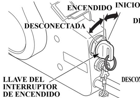
Este control remoto está equipado con un interruptor de encendido del tipo llave. En el tipo de montaje empotrado (tipo D1) y el tipo de montaje superior (tipo D2), el interruptor del motor está situado en el panel del interruptor de la llave.
