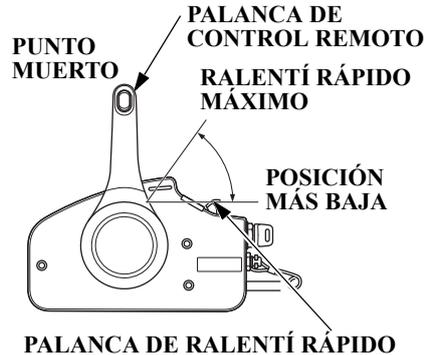
La palanca de ralentí rápido no se moverá a menos que la palanca de control remoto esté en la posición PUNTO MUERTO. A la inversa, la palanca de control remoto no se moverá a menos que la palanca de ralentí rápido esté en la posición más baja.
