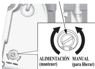
Si el interruptor de trimado/inclinación motorizados no hace inclinar el motor fueraborda, podrá inclinar manualmente el motor fueraborda hacia arriba o hacia abajo abriendo la válvula de descarga manual. Para inclinar manualmente el motor fueraborda, gire la válvula de alivio manual, de debajo de la ménsula de popa izquierda, no más de 1 ó 2 vueltas hacia la izquierda empleando un destornillador.
