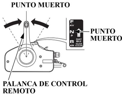
2. Coloque la palanca de control remoto en la posición de PUNTO MUERTO.
