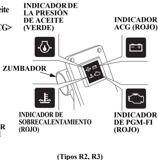
zumbador de forma continua en el tipo de control remoto. El régimen del motor no podrá aumentarse con una mayor apertura del acelerador hasta que se solucione el mal funcionamiento.
