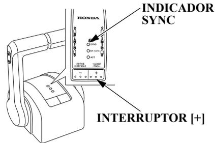
El cambio de marcha y ajuste del régimen del motor de todos los motores fueraborda puede realizarse con una sola palanca de control remoto estando en modo monopalanca.
