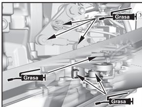
**PIVOTE DEL CAMBIO/SOPORTE/ BRAZO DEL CAMBIO/CILINDRO DEL BRAZO DEL TRINQUETE (TIPO DBW)**
