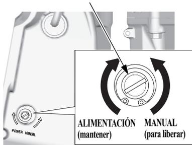
Cuando el sistema de trimado/ inclinación motorizados no funciona debido a que la batería se ha agotado o a la avería del motor de trimado/ inclinación, el motor fueraborda puede inclinarse manualmente hacia arriba o hacia abajo accionando la válvula de descarga manual. Para inclinar manualmente el motor fueraborda, gire 1 o 2 vueltas hacia la izquierda la válvula de descarga manual situada debajo de la ménsula de popa utilizando un destornillador.
