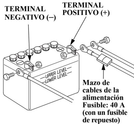
3. Conecte el cable positivo de la batería (+) al terminal positivo de la misma (+) y luego el cable negativo (-) al terminal negativo de la misma (-). Apriete pernos y tuercas con seguridad. Recubra los terminales de la batería con grasa.
