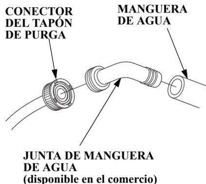
6. Conecte una manguera de agua potable a la junta de la manguera de agua.
