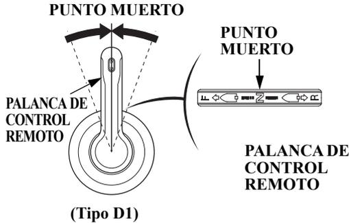
2. Coloque la palanca de control remoto en la posición de PUNTO MUERTO. El motor no arrancará a menos que la palanca de control esté en la posición de PUNTO MUERTO.
