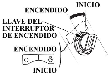
3. Gire la llave del interruptor de encendido a la posición INICIO hasta que el motor arranque. Cuando el motor arranque, suelte la llave dejándola volver a la posición ON.
