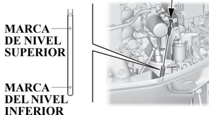
Compruebe el nivel de aceite del motor con el motor parado y el motor fueraborda en posición vertical.
