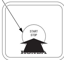
2. Pulse el interruptor de encendido/parada para parar el motor.
