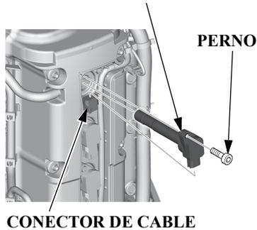
5. Desconecte el conector del cable de la bobina de encendido presionando sobre la lengüeta de bloqueo y tirando del conector. Tire del conector de plástico, no de los cables.
