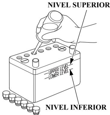
3. Llene la batería con agua destilada hasta la línea de nivel superior. Nunca llene demasiado la batería.
