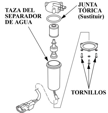
5. Extraiga los tres tornillos que sujetan el filtro de combustible con separador de agua, y elimine el agua o los sedimentos del interior de la taza.
