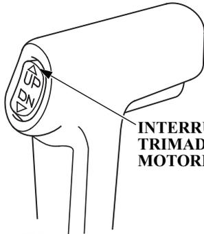
**INTERRUPTOR DE TRIMADO/INCLINACIÓN MOTORIZADOS**
