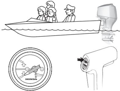
Con el motor fueraborda trimado bajo, el medidor de trimado indicará tal como se muestra. Para subir el casco, aumente el ángulo de trimado del motor fueraborda presionando la parte UP (arriba) del interruptor de trimado/inclinación motorizados.
