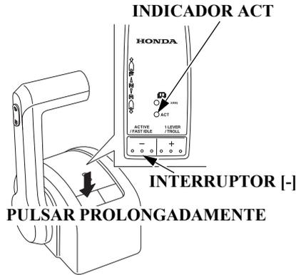
En caso de varias estaciones, utilice el interruptor [-] para cambiar de estación operativa.
