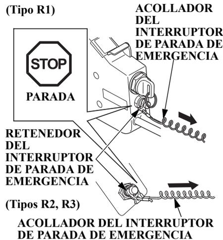
Tire de la cuerda ondulada del interruptor de parada de emergencia y quite la placa de bloqueo del interruptor. Esto parará el motor.
