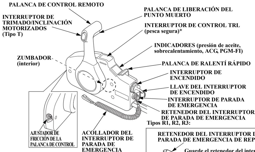
\* Para el tipo equipado con interruptor de control TRL (pesca segura).
