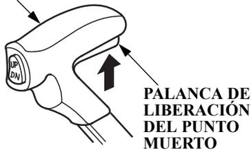
La palanca de liberación de punto muerto está puesta en la palanca de control remoto para impedir un accionamiento involuntario de la palanca de control remoto.
