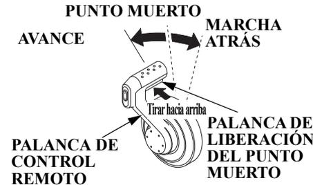
Utilice el interruptor [-] y la palanca de control remoto para ajustar la velocidad del motor sin cambiar de marcha cuando esté calentando el motor.
