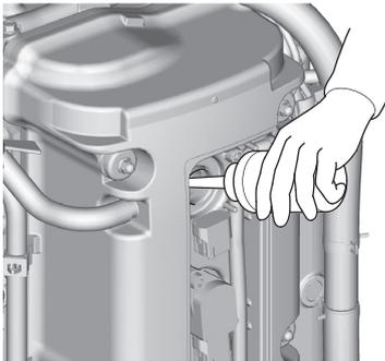
5. Vierta una cucharadita pequeña de aceite de motor en el orificio de cada bujía para lubricar el interior de los cilindros.
