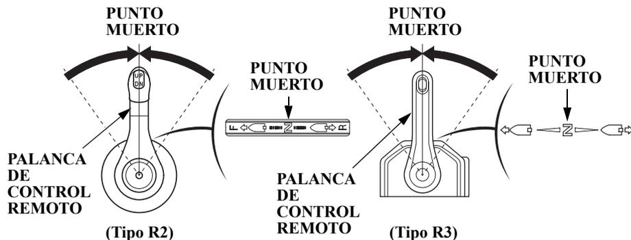
2. Coloque la palanca de control remoto en la posición de PUNTO MUERTO.
