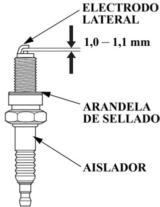
9. Mida el entrehierro con un calibrador de separaciones del tipo de alambre. Los huelgos deberán ser de 1,0 – 1,1 mm. Corrija según sea necesario, doblando con cuidado el electrodo lateral.
