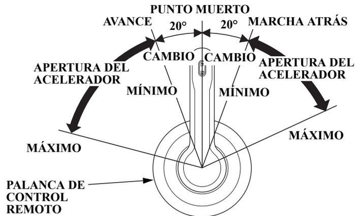
Cambiar a marcha adelante, marcha atrás o punto muerto y el ajuste de la velocidad del motor puede realizarse con la palanca de control remoto. Es necesario tirar de la palanca de liberación de punto muerto para operar la palanca de control remoto.
