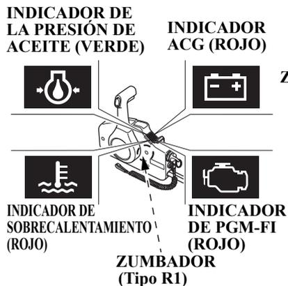
Si se reduce la presión del aceite de motor y/o se sobrecalienta el motor, puede activarse uno o ambos sistemas de advertencia.
