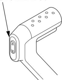
INTERRUPTOR DE TRIMADO/INCLINACIÓN MOTORIZADOS
