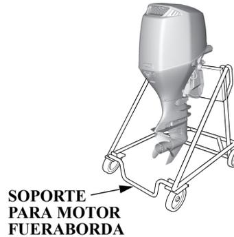
Transporte y guarde el motor fueraborda en posición vertical u horizontal como se muestra arriba. Fije la ménsula de popa al soporte y fije el motor fueraborda con los pernos y las tuercas. Guarde el motor fueraborda en un lugar bien ventilado que no reciba la luz directa del sol y que no tenga humedad.
