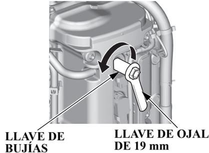
7. Utilice una llave de bujías y una llave de tuercas de 19 mm para extraer las bujías.
