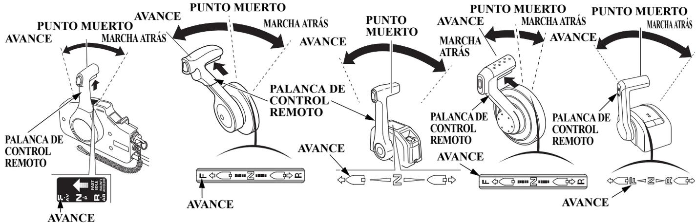
2. Mueva la palanca de control desde la posición de PUNTO MUERTO hacia la posición de AVANCE.
