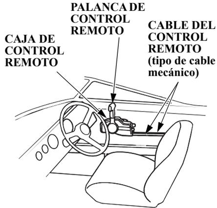
Instale la caja de control remoto en una posición en la que sea fácil de operar la palanca de control remoto y el interruptor.
