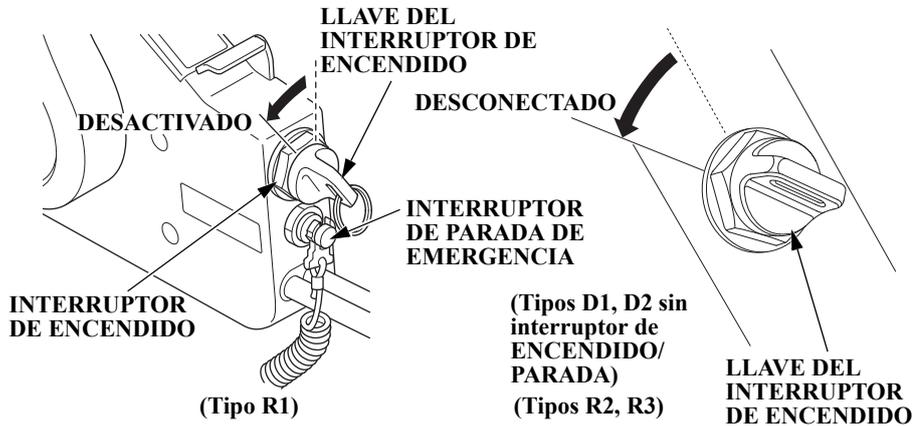
2. Gire la llave del interruptor de encendido a la posición OFF para parar el motor.
