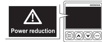
Este motor fueraborda está provisto de un sistema de reducción de potencia que se activa cuando el motor fueraborda tiene un problema grave.
