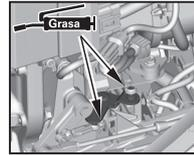
**BARRA DEL ACELERADOR/ CONEXIÓN (TIPO DE CABLE MECÁNICO)**
