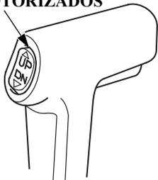
INTERRUPTOR DE TRIMADO/INCLINACIÓN MOTORIZADOS
