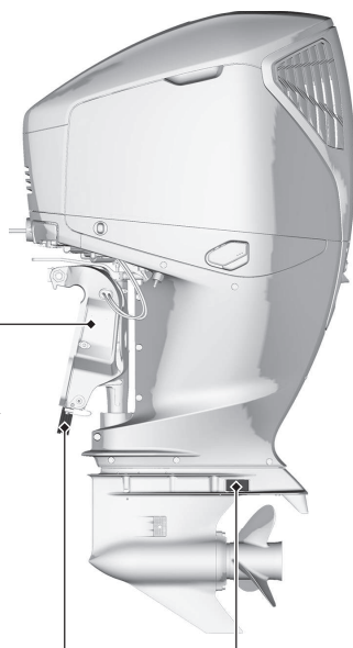
アノードメタルの損傷、 腐食、がた（49頁参照）
