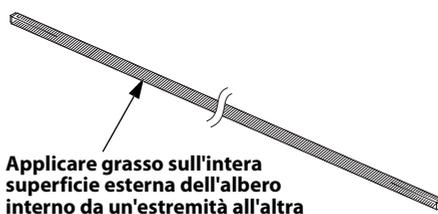
7. Inserire l'albero interno nel gruppo albero flessibile per eseguire il montaggio.
