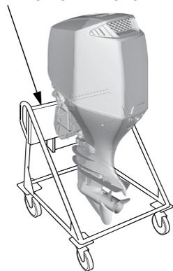
3. Fissare il motore fuoribordo sull'apposito cavalletto portamotore con i relativi bulloni e dadi di fissaggio.
