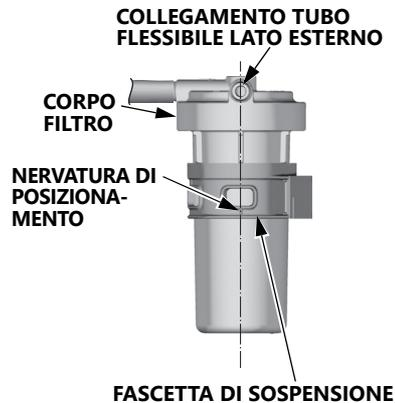
7. Quando si collega la fascetta di sospensione al filtro carburante con il separatore d'acqua, allineare la nervatura di posizionamento della fascetta di sospensione con il collegamento del tubo flessibile lato ESTERNO nel corpo del filtro, come mostrato in figura.
