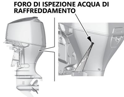
Tramite questo foro è possibile controllare se l'acqua di raffreddamento all'interno del motore circola regolarmente.
