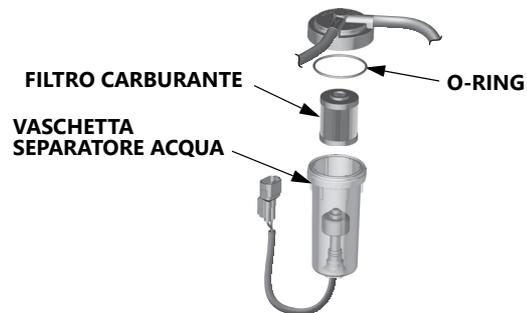
4. Ruotare verso sinistra la vaschetta del filtro carburante con separatore d'acqua per rimuoverla, quindi rimuovere l'eventuale presenza di acqua o sedimenti dall'interno della vaschetta.
