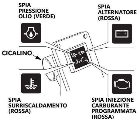
Se la pressione dell'olio diminuisce e/o il motore si surriscalda, si potrebbe verificare l'accensione di una o di entrambe le spie di notifica anomalia.
