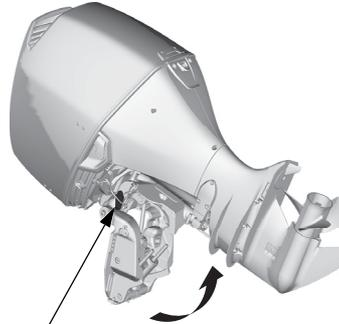
LEVA DI BLOCCAGGIO INCLINAZIONE (su ogni lato)
