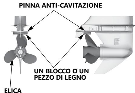
Durante la sostituzione dell'elica, mettere un blocco o pezzo di legno adeguato tra l'elica e la piastra anticavitazione per impedire la rotazione dell'elica.
