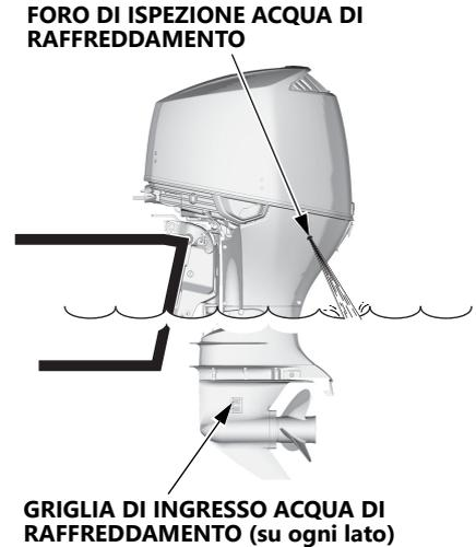
4. Dopo aver avviato il motore, controllare se l'acqua di raffreddamento defluisce dal foro di ispezione acqua di raffreddamento. La quantità di acqua che defluisce potrebbe variare in base al funzionamento del termostato, ma ciò rientra nella norma.
