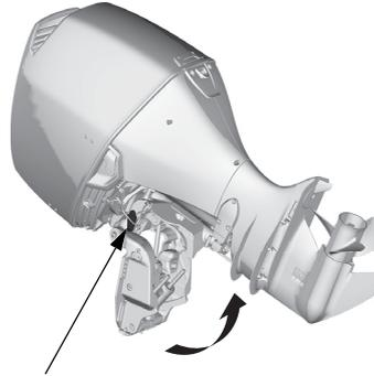
LEVIER DE VERROUILLAGE D'INCLINAISON (de chaque côté)
