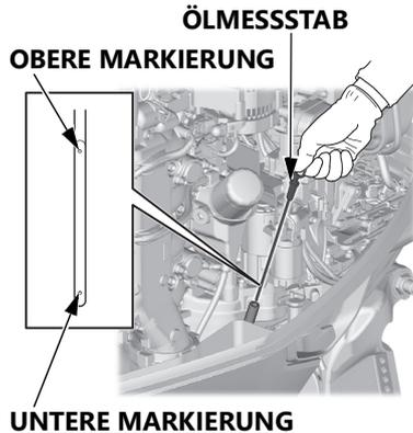
6. Mit dem empfohlenen Motoröl bis zur oberen Markierung am Ölmesstab auffüllen.
