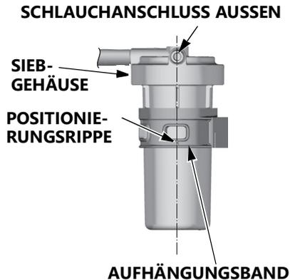
7. Richten Sie beim Anbringen des Aufhängungsbands am Kraftstofffilter mit Wasserabscheider wie in der Abbildung dargestellt die Positionierungsrippe des Aufhängungsbands am Schlauchanschluss AUSSEN im Siebgehäuse aus.
