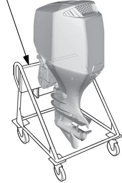
3. Den Außenbordmotor auf einem Außenbordmotorständer mit den Befestigungsschrauben und -muttern sichern.
