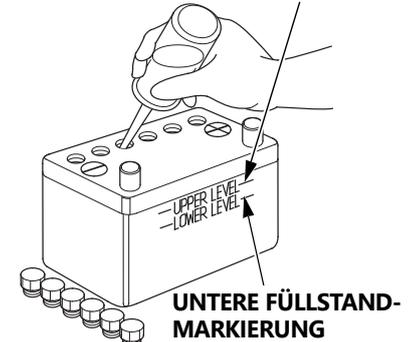
3. Die Batterie bis zur oberen Füllstandlinie mit destilliertem Wasser befüllen. Darauf achten, dass die Batterie nicht überfüllt wird.
