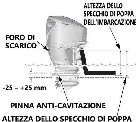
La piastra anticavitazione del motore fuoribordo dovrebbe trovarsi tra -25 e +25 mm dal fondo dell'imbarcazione. Le dimensioni corrette differiscono in base al tipo di barca e alla configurazione del fondo dell'imbarcazione. Seguire le indicazioni fornite dal produttore relative all'altezza di installazione raccomandata.
