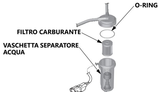
5. Ruotare verso sinistra la vaschetta del filtro carburante con separatore d'acqua per rimuoverla, quindi rimuovere l'eventuale presenza di acqua o sedimenti dall'interno della vaschetta.
