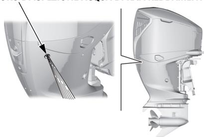
Tramite questo foro è possibile controllare se l'acqua di raffreddamento all'interno del motore circola regolarmente.
