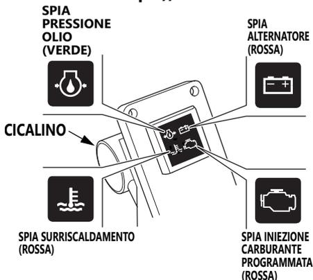
Se la pressione dell'olio diminuisce e/o il motore si surriscalda, si potrebbe verificare l'accensione di una o di entrambe le spie di notifica anomalia.
