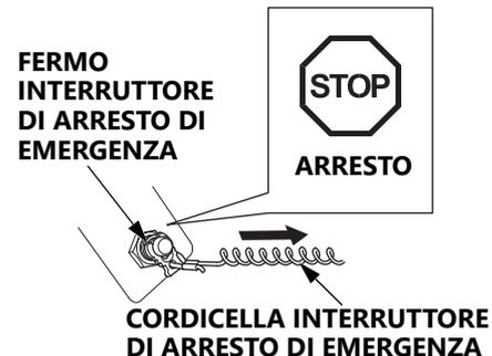
Tirare la cordicella dell'interruttore di arresto di emergenza per rimuovere la piastra di bloccaggio dall'interruttore; questa operazione arresterà il motore.
