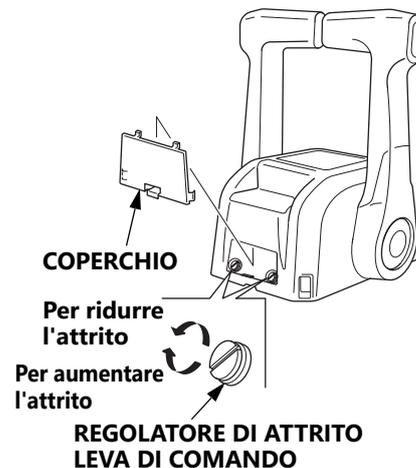
Controllare se la leva di comando a distanza si muove scorrevolmente.
