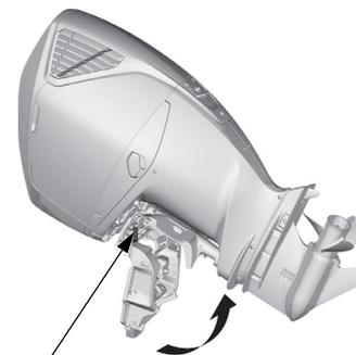
**LEVA DI BLOCCAGGIO INCLINAZIONE (su ogni lato)**
