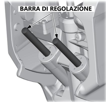
3. Premere DN (giù) sull'interruttore power trim/tilt fino al completo accorciamento delle barre di regolazione assetto.
