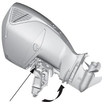
LEVA DI BLOCCAGGIO INCLINAZIONE (su ogni lato)
