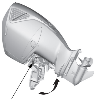
LEVIER DE VERROUILLAGE D'INCLINAISON (de chaque côté)
