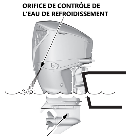
ORIFICE D'ADMISSION DE L'EAU DE REFROIDISSEMENT (de chaque côté)
