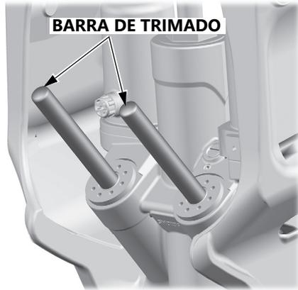
3. Presione la parte DN (abajo) del interruptor de trimado/inclinación motorizados y acorte al máximo las barras de trimado.
