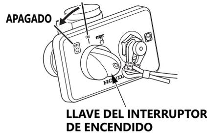
2. Gire la llave del interruptor de encendido a la posición OFF para parar el motor.
