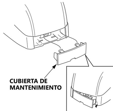
1. Retire la cubierta de mantenimiento.
