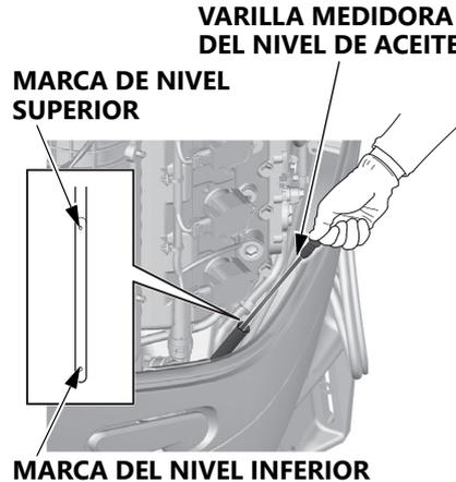
Compruebe el nivel de aceite del motor con el motor parado y el motor fueraborda en posición vertical.
