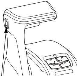
**INTERRUPTOR DE TRIMADO/INCLINACIÓN MOTORIZADOS**
