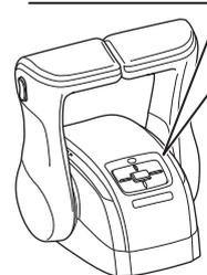
Los interruptores de selección se utilizan para las operaciones en el modo de ralentí rápido, el modo de control de pesca segura, el modo monopalanca, el modo activo, el modo de control de crucero y el modo de trimado de apoyo.
