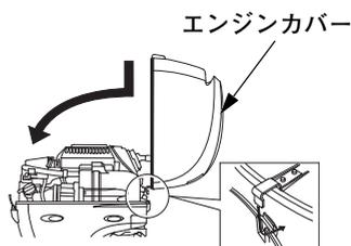
3. 点検または補給後、エンジンカバーを確実に取付けて、固定レバーで固定します。
