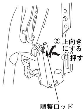
2. 船外機が適正な取付け角度になるように調整ロッドを差し換え、ロッドを下向きにして固定します。
