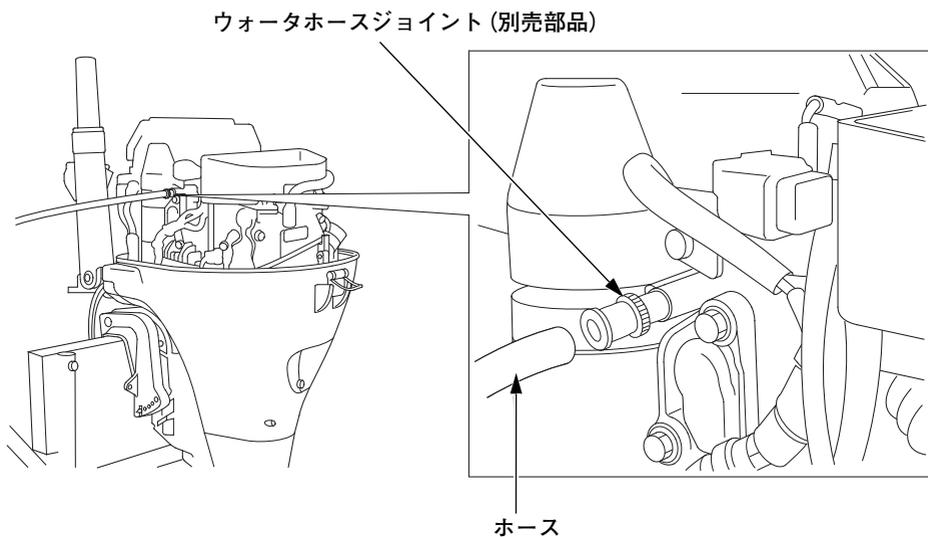
ホースに市販品のアタッチメントを取り付けている場合はウォーターホースジョイントキットを使用して接続して下さい。
