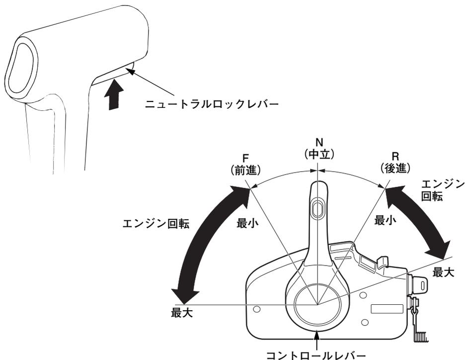
F (前進) … レバーを“F” (前進) 位置まで動かすと前進ギアに入ります。さらにレバーを F 方向に動かすとエンジンの回転が上がり、ボートのスピードが速くなります。
