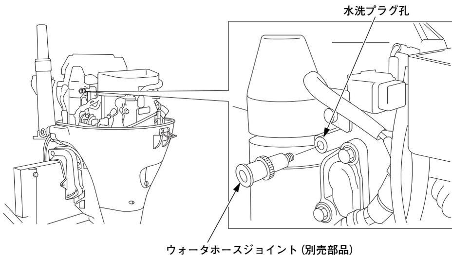
6. ウォーターホースジョイントに水道のホースを接続し、水を流します。
