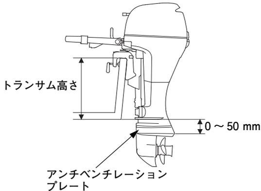
船外機の取付け高さが適正でないと下記の症状が発生します。
