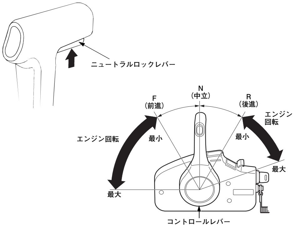
F (前進) … レバーを “F” (前進) 位置まで動かすと前進ギアに入れります。さらにレバーを F 方向に動かすとエンジンの回転が上がり、ボートのスピードが速くなります。
