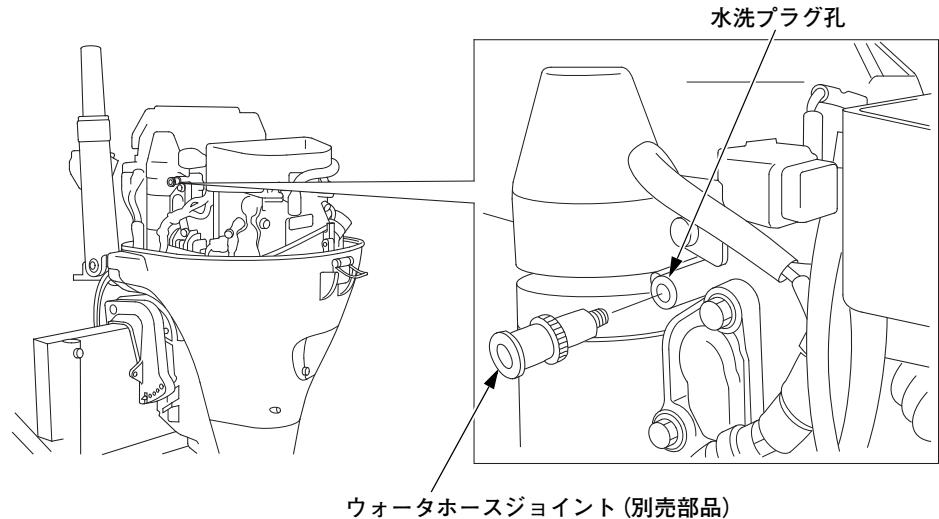
6. ウォーター ホース ジョイントに水道のホースを接続し、水を流します。
