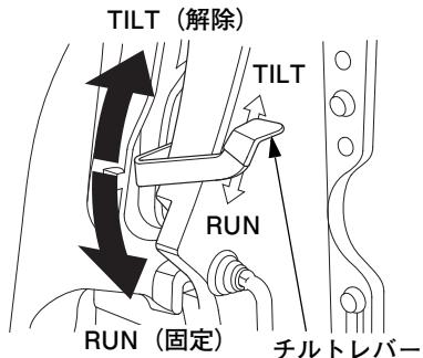
4. 元の位置に戻すときは、エンジンカバーのグリップをもって船外機をささえ、チルトレバーを“TILT”（解除）の位置にしてゆっくりとおろします。おろした後、チルトレバーを“RUN”（固定）の位置にしてください。
