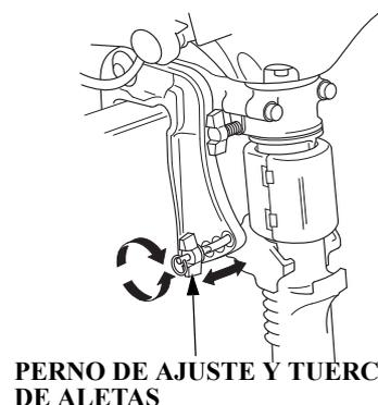
Emplee el perno de ajuste para ajustar el ángulo del motor fueraborda en la posición de funcionamiento normal. El ángulo del motor fueraborda podrá ajustarse a los cuatro ángulos cambiando la posición del perno de ajuste.
