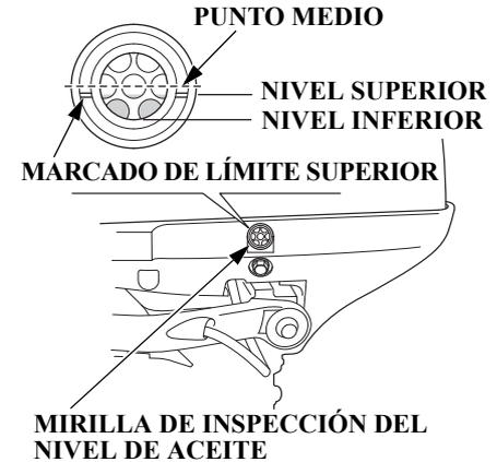
1. Ponga el motor fueraborda en posición vertical y nivelado, y compruebe el nivel de aceite a través de la mirilla de inspección.
