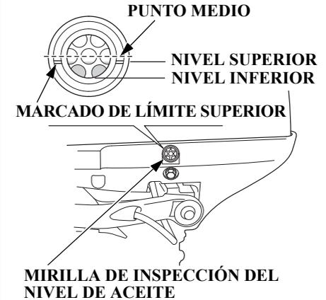
Emplee la mirilla de inspección del nivel de aceite para comprobar el nivel de aceite con el motor parado y el motor fueraborda en la posición recta vertical.
