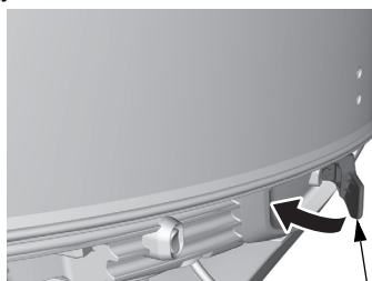
エンジンカバー固定レバー (左右両側)
