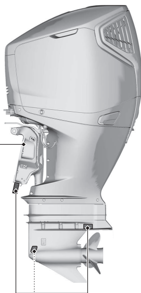
アノードメタルの損傷、 腐食、がた（41頁参照）
