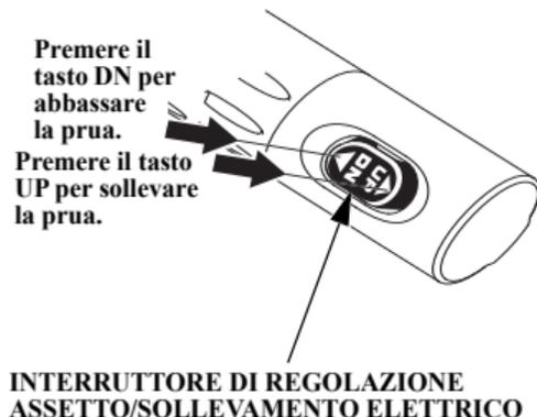
fine di raggiungere la velocità massima, ottimizzare le prestazioni di guida e il consumo di carburante. Premere il pulsante UP (sollevamento) o DN (abbassamento) sull'interruttore di regolazione assetto/sollevamento elettrico e posizionare il motore fuoribordo
