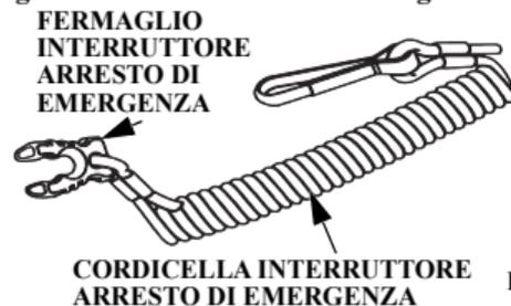
La cordicella dell'interruttore di arresto di emergenza consente di arrestare immediatamente il motore qualora l'operatore cada in acqua o lontano dal motore fuoribordo.
