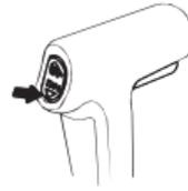
Con il motore fuoribordo regolato alto, l'indicatore di regolazione riporterà il valore illustrato in figura. Per abbassare la prua, diminuire l'angolo di assetto premendo il lato DN dell'interruttore di regolazione assetto/sollevamento elettrico.
