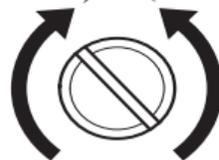
Dopo aver sollevato il motore fuoribordo, ruotare la valvola di sblocco manuale in senso orario.
