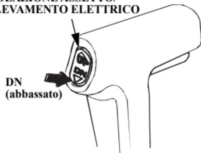
1. Premere il pulsante DN (abbassato) sull'interruttore di regolazione assetto/sollevamento elettrico e abbassare al massimo il motore fuoribordo.
