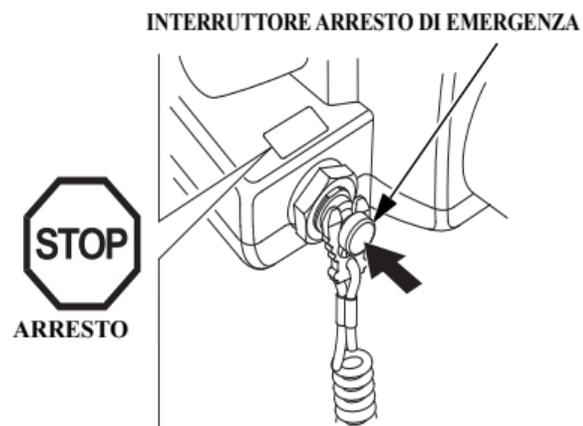
Premere l'interruttore di arresto di emergenza per arrestare il motore.
