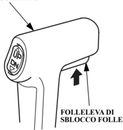
La leva di sblocco folle è posizionata sulla leva di comando e ne impedisce il funzionamento accidentale.
