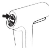
Con il motore fuoribordo posizionato in basso, il misuratore di assetto riporterà il valore illustrato in figura. Per sollevare la prua, incrementare l'angolo di assetto del motore, premendo il lato UP dell'interruttore di regolazione assetto/sollevamento elettrico.
