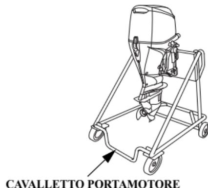
Trasportare e stoccare il motore in posizione verticale o orizzontale, come mostrato in figura. Agganciare la staffa di poppa al cavalletto e fissare il motore fuoribordo con bulloni e dadi. Conservare il motore fuoribordo in un'area ben ventilata, al riparo dai raggi solari e dall'umidità.
