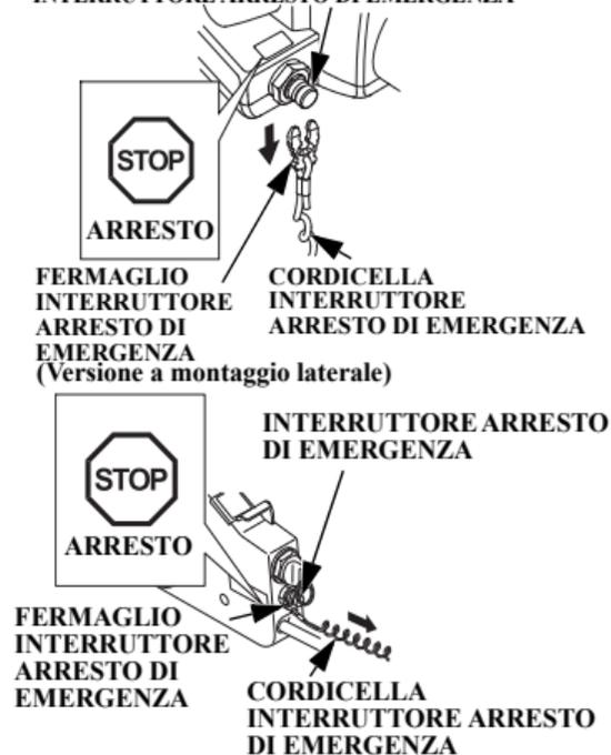
Per arrestare il motore in caso di emergenza, sfilare dalla sede il fermaglio dell'interruttore di arresto di emergenza, tirando la cordicella.
