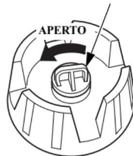
3. Ruotare la manopola di sfiato del tappo di riempimento carburante completamente in senso antiorario per aprire lo sfiato.
