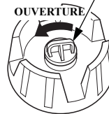
BOUTON DE MISE À L'AIR LIBRE DU BOUCHON DE REMPLISSAGE DE CARBURANT
