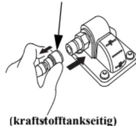
Kraftstoffleitungsverbinder und -anschlussstück dienen zum Anschluss der Kraftstoffleitung an den Kraftstofftank und den Außenbordmotor.
