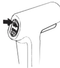
Bei zu niedrig getrimmtem Außenbordmotor hat die Trimmanzeige das dargestellte Erscheinungsbild. Um den Bug anzuheben, erhöhen Sie den Außenbordmotortrimmwinkel, indem Sie UP des Power Trim/Tilt-Schalters drücken.
