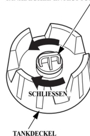
2. Den Tankdeckel und Lüftungsknopf sicher schließen.
