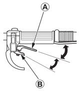
A : You can control the rotation speed. 您可以控制轉速。
