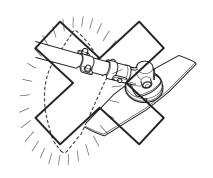
BEFORE STARTING ENGINE, CHECK THAT BLADE IS RAISED OFF GROUND. 起動引擎前,檢查刀片是否已離開地面。
