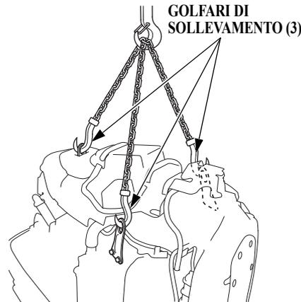
Prima di installare il motore fuoribordo sull'imbarcazione, sollevare il motore con una gru o un dispositivo equivalente, fissando i tre golfari di sollevamento sul fuoribordo. Utilizzare una gru in grado di sopportare carichi pari o superiori a 300 kg.
