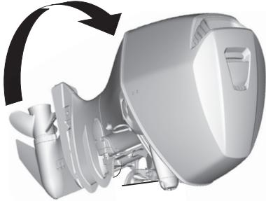
Sollevare il motore fuoribordo verso l'alto utilizzando la leva di bloccaggio del sollevamento in fase di ormeggio dell'imbarcazione. Porre la leva di controllo a distanza in posizione NEUTRAL (folle) e arrestare il motore prima di inclinare verso l'alto il motore fuoribordo.
