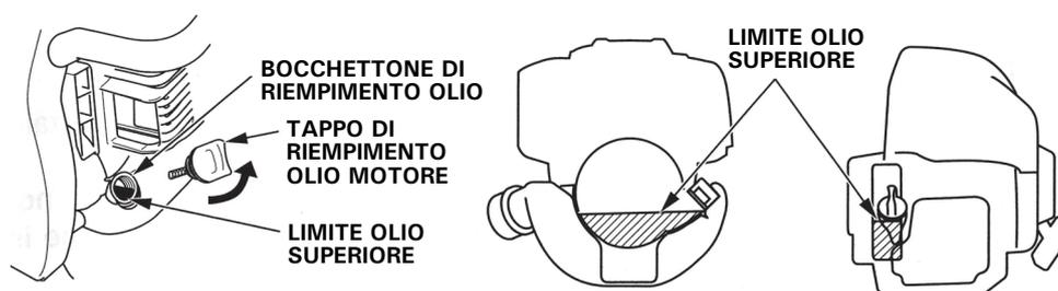
Usare olio per motori a 4 tempi che sia almeno conforme ai requisiti per la classificazione API SE o successive (o equivalenti). Controllare sempre l'etichetta del servizio API sul contenitore dell'olio per accertarsi che siano riportate le lettere SE o una classificazione successiva (o equivalente).
