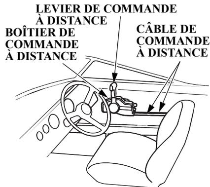
Installer le boîtier de commande à distance dans une position dans laquelle le levier de commande à distance et les contacteurs seront faciles à actionner.
