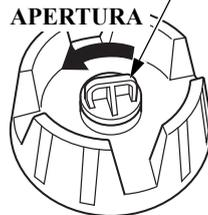
3. Ruotare completamente il pomello di sfiato del tappo di riempimento carburante per aprire la bocchetta.
