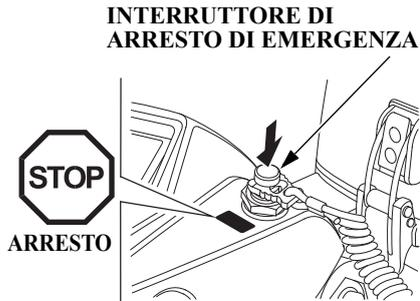
Tenere premuto l'interruttore di arresto di emergenza per fermare il motore.
