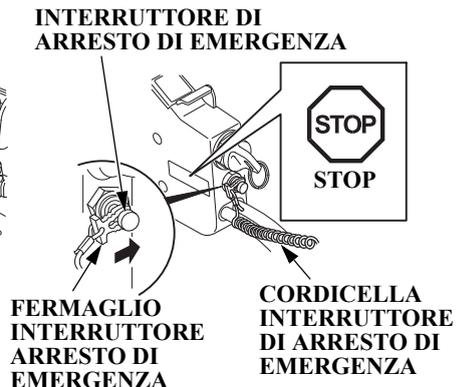
8. Inserire il fermaglio all'estremità della cordicella dell'interruttore di arresto di emergenza in detto interruttore.
