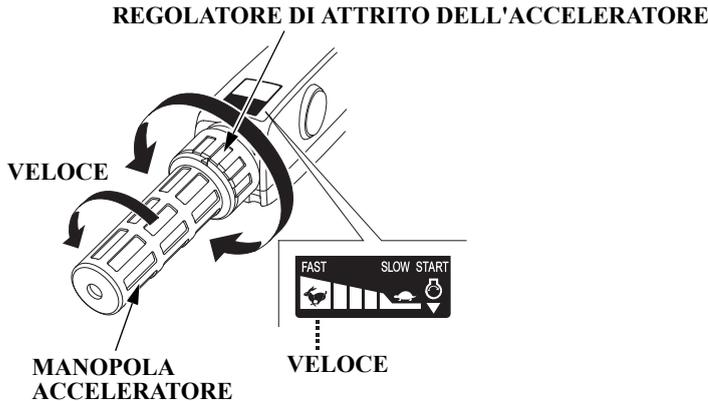
3. Per aumentare la velocità, ruotare la manopola dell'acceleratore in direzione VELOCE. Per un risparmio di carburante, è consigliabile mantenere un'apertura della farfalla pari a circa l'80% della capacità massima.
