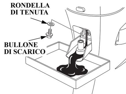
4. Rimuovere il bullone di scarico olio e la rondella di tenuta utilizzando la chiave da 12 mm e scaricare l'olio motore.
