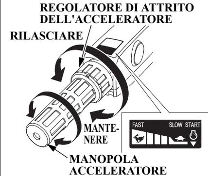
Il regolatore di attrito dell'acceleratore regola la resistenza della rotazione della manopola dell'acceleratore.
