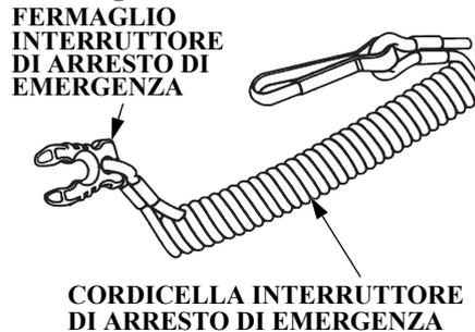
La cordicella dell'interruttore di arresto di emergenza consente l'arresto immediato del motore, se l'operatore dovesse cadere in acqua o dovesse trovarsi lontano dai comandi.
