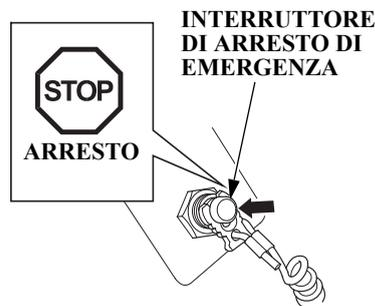
Tenere premuto l'interruttore di arresto di emergenza per fermare il motore.
