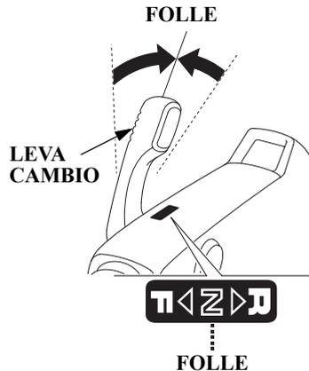
1. Ruotare la manopola dell'acceleratore in posizione LENTA e muovere la leva del cambio su FOLLE.
