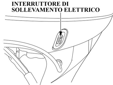
Quando si è lontani dall'interruttore di regolazione assetto/ sollevamento elettrico posto sul lato della leva di controllo, è possibile azionare l'interruttore di sollevamento elettrico sul lato del motore fuoribordo. Il funzionamento dell'interruttore è identico a quello dell'interruttore di regolazione assetto/ sollevamento elettrico posto sul lato della leva di comando.
