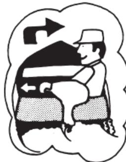
Pour changer la direction du canot vers la droite, tourner la barre de direction vers la gauche. Pour virer à gauche, tourner la barre de direction vers la droite.
