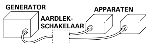
Aansluiting op één aardlekschakelaar
